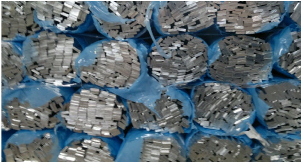
FOTO DI ESEMPIO: MICRO PROFILI ESTRUSI IN ALLUMINIO - PROFILI IN ALLUMINIO DI PICCOLE DIMENSIONI
