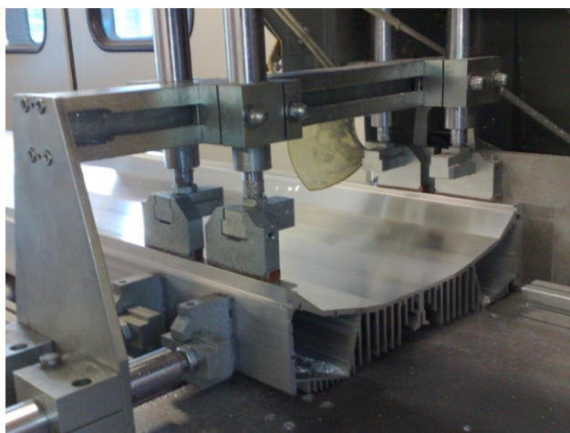
FOTO DI ESEMPIO: TAGLIO PROFILO IN ALLUMINIO ESTRUSO PER LED DI GROSSE DIMENSIONI
