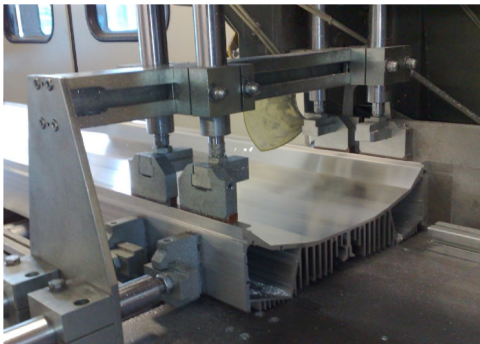
FOTO DE EJEMPLO: CORTE DE PERFILES DE ALUMINIO INCLUSO DE GRANDES DIMENSIONES
