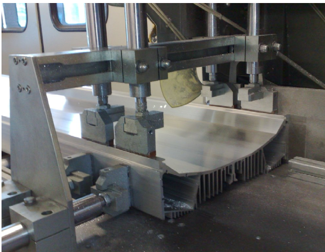
BEISPIELFOTO: SCHNEIDVORGÄNGE NACH MASS WERDEN AN ALUMINIUMPROFILIEN DURCHGEFÜHRT
