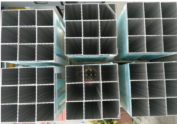
EXEMPLE DE PHOTO : PROFILÉS EN ALUMINIUM GRANDES BOITES
