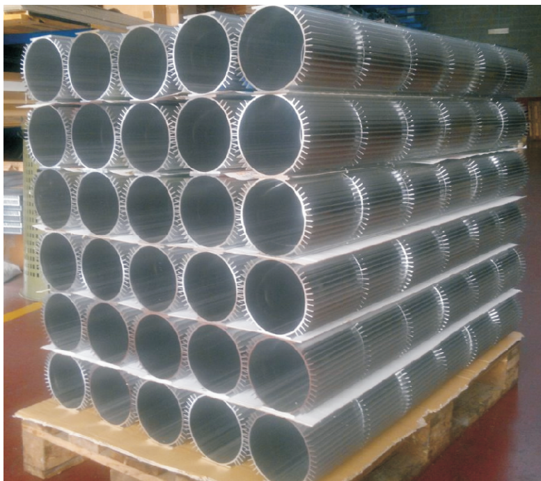
FOTO DI ESEMPIO: PROFILI IN ALLUMINIO ESTRUSO PER CARCASSE DI MOTORI ELETTRICI
