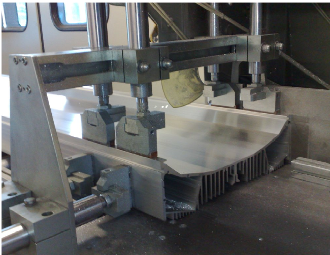
BEISPIELFOTO: SCHNEIDVORGÄNGE NACH MASS WERDEN AN ALUMINIUMPROFILIEN DURCHFÜHRT
