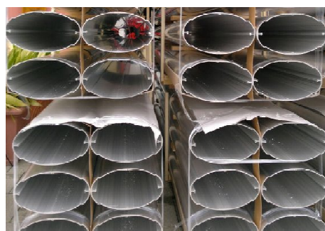
BEISPIELFOTO: ALUMINIUMSTRANGSTÜCKE FÜR BELEUCHTUNGSKÖRPER
