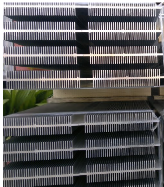
EXEMPLE DE PHOTO : DISSIPATEURS DE CHALEUR A GRAND PEIGNE DOUBLE
