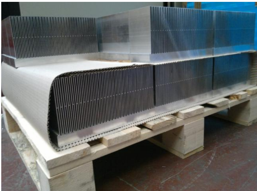
FOTO DI ESEMPIO: TAGLIO A MISURA DISSIPATORI AD ALTO RENDIMENTO DI GROSSE DIMENSIONI
