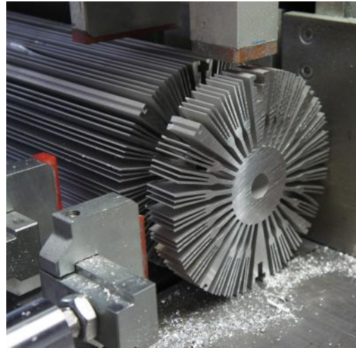
FOTO DI ESEMPIO: TAGLIO A MISURA DI DISSIPATORI "FLOWER" ANCHE DI GROSSE DIMENSIONI
