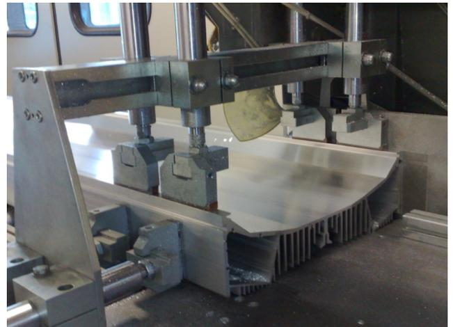
FOTO DI ESEMPIO: TAGLIO PROFILO IN ALLUMINIO ESTRUSO PER LED DI GROSSE DIMENSIONI
