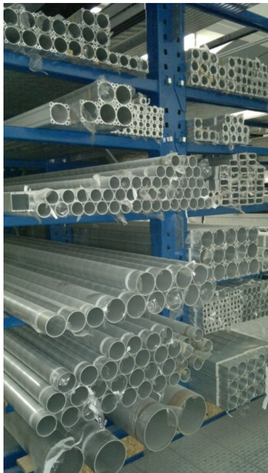
FOTO DI ESEMPIO: PROFILI IN ALLUMINIO ESTRUSO CANNE PER LA REALIZZAZIONE DI CILINDRI PNEUMATICI
