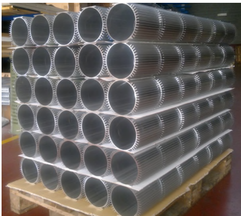
EXEMPLE DE PHOTO : PROFILÉS EN ALUMINIUM EXTRUDÉ POUR CARTERS DE MOTEUR ÉLECTRIQUE
