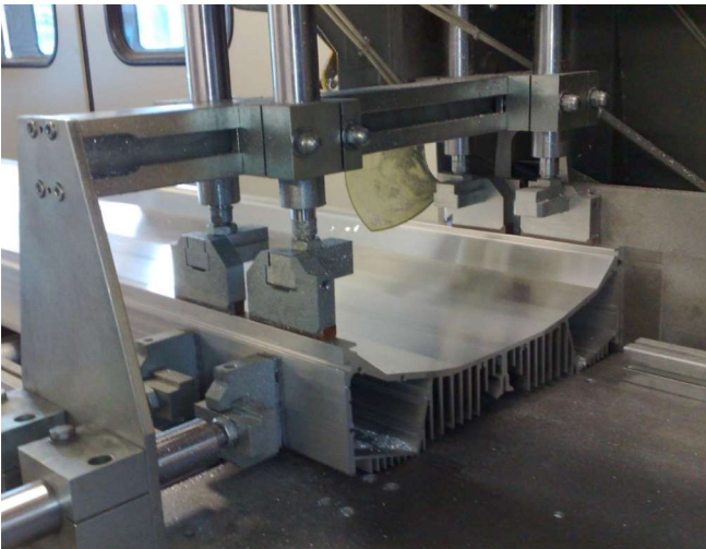
FOTO DI ESEMPIO: SI ESEGUONO OPERAZIONI DI TAGLIO A MISURA SU PROFILI IN ALLUMINIO
