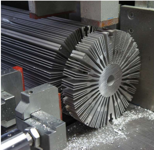
FOTO DI ESEMPIO: SI ESEGUONO OPERAZIONI DI TAGLIO A MISURA SU PROFILI IN ALLUMINIO
