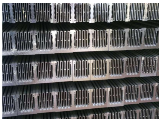
FOTO DI ESEMPIO: PROFILI IN ALLUMINIO ESTRUSI SECONDO IL DISEGNO DEL CLIENTE - CUSTOM -
