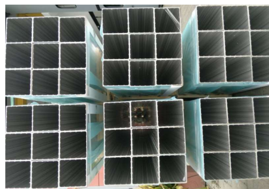
FOTO DI ESEMPIO: PROFILI IN ALLUMINIO SCATOLATI DI GRANDI DIMENSIONI
