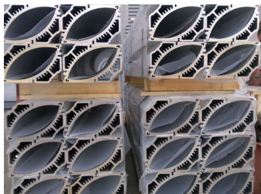
FOTO DI ESEMPIO: PROFILI IN ALLUMINIO ESTRUSI SECONDO IL DISEGNO DEL CLIENTE - CUSTOM -
