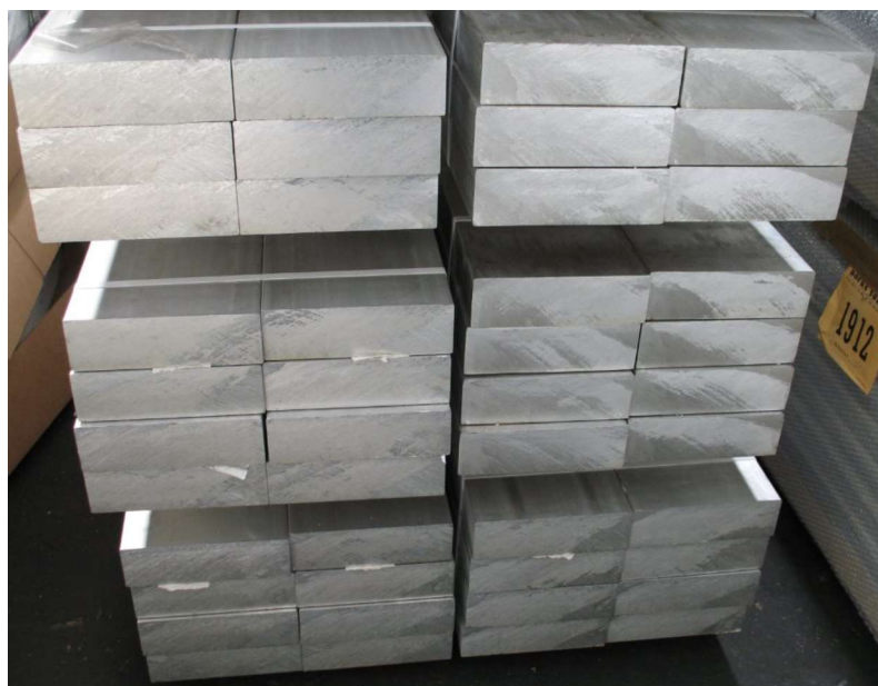
FOTO DI ESEMPIO : PROFILI IN ALLUMINIO ESTRUSO PIATTI DI GRANDI DIMENSIONI LEGA 6060 - 6082
